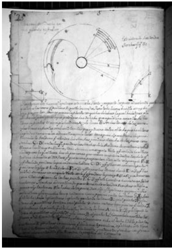
Fig. 2. Diseño de escalera de caracol de macho en una planta esférica. Manuscrito n° 114 del A.P.E.S.
