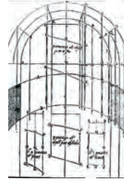
Trazado del arco de directriz curva o "cavado en torre redonda", según Philibert de l'Orme.
